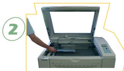
Mise en place du Durablack dans la graveuse laser
